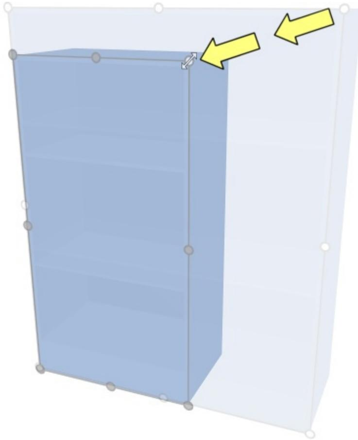
4. **Solte o botão do mouse.** Os móveis são redimensionados. Observe que o espaçamento entre prateleiras e painéis é recalculado automaticamente, mantendo a espessura desses componentes.
